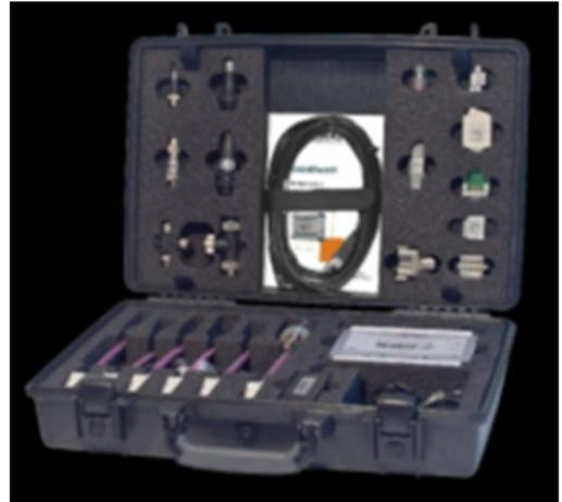
CAN-Bus тестер 2 – универсальный инструмент для ввода в эксплуатацию, анализа, наблюдения, поиска ошибок и обслуживания установок на основе CAN-Bus шин.
